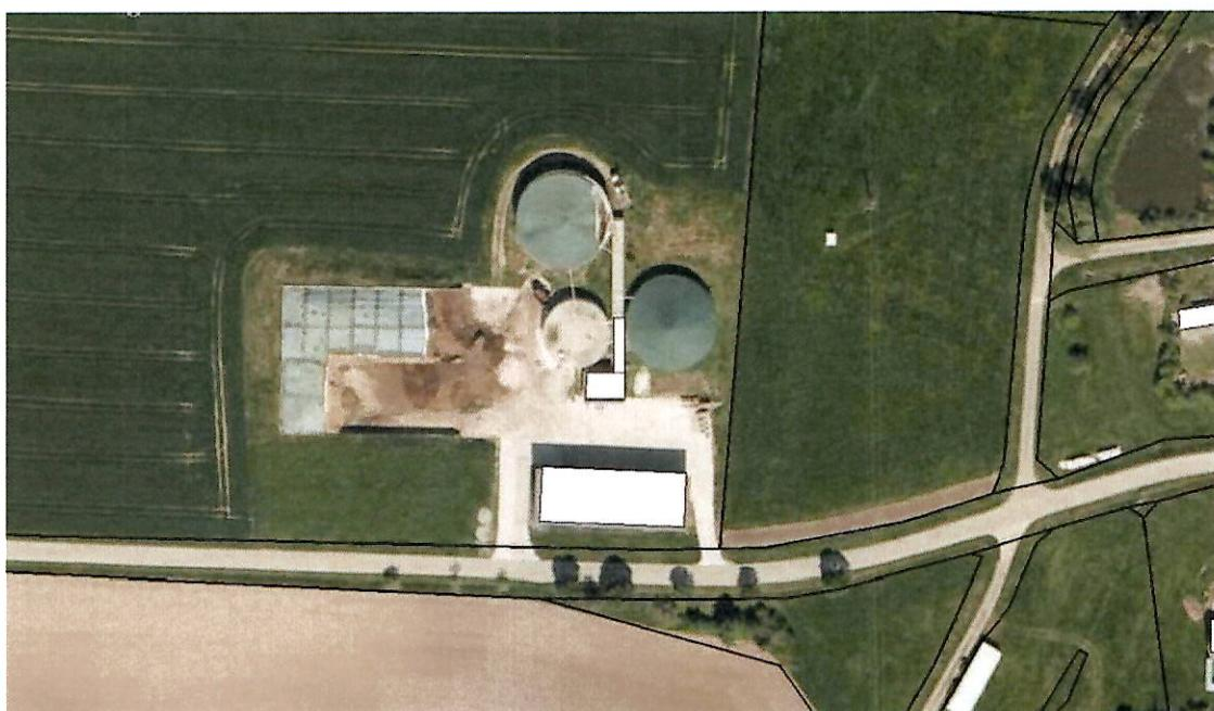
Auf Flurnummer 466 Gemarkung Banzenweiler findet sich eine landwirtschaftliche Halle mit Biogasanlage. Die Biogasanlage besteht aus 4 Gärbehältern (1 Gärbehälter und der Pufferspeicher noch nicht im Luftbild sichtbar), ein BHKW-Gebäude, ein Pufferspeicher und eine Fahrsiloanlage.
