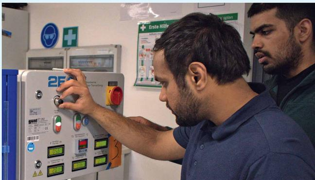
An der Solarthermieanlage regeln die Studierenden die Pumpleistung und beobachten dabei die Temperatur im System.
