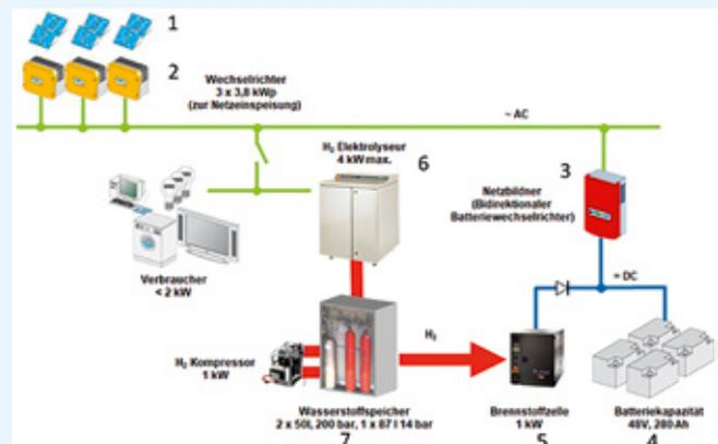
(1) Photovoltaik-Anlage mit (2) Wechselrichter, (3) Inselnetzwechselrichter, (4) Batteriespeicher, (5) Brennstoffzelle, (6) Elektrolyseur und (7) Druckgasspeicherstation.
