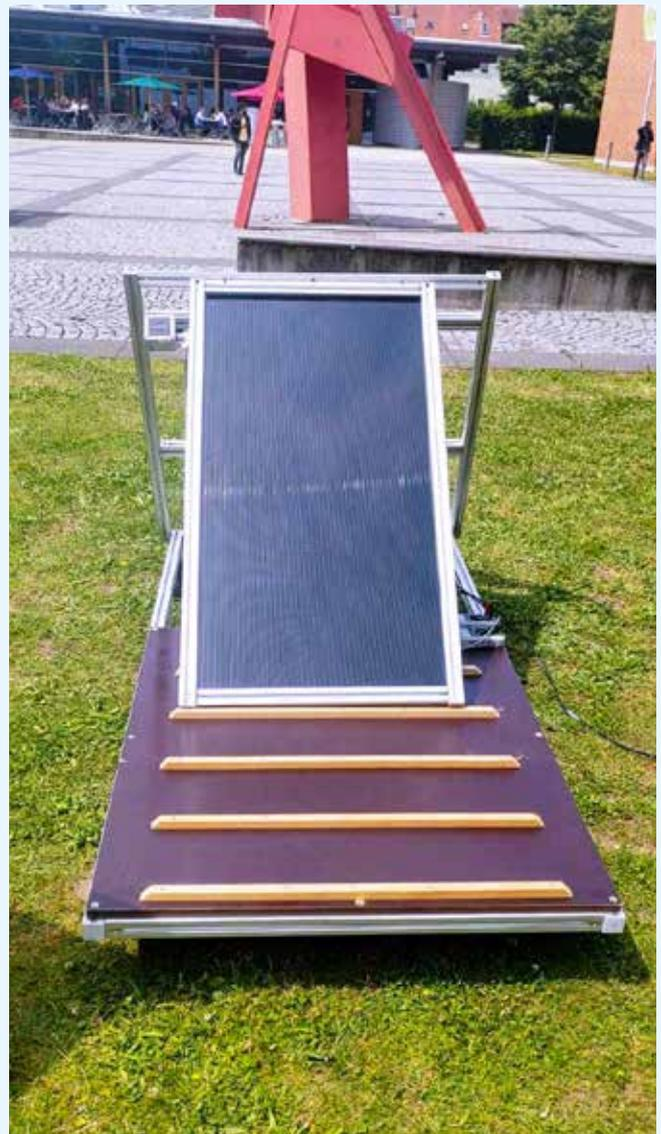
Versuchsaufbau um die Neigung des PV-Moduls und damit den Einstrahlwinkel zu variieren
