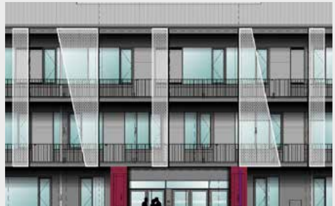
Die Fassadenansicht der neuen Land-Schule im Detail: der Schulverband hat in seiner jüngsten Sitzung für eine Fassadengestaltung mit weißen Streckmetallgitter gestimmt.
