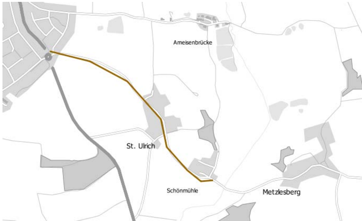
Karte 13: nutzbares Leerrohre (160mm) der Stadt; Trasse von Feuchtwangen nach Schönmühle
